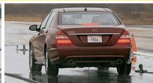
**Die Bremsmessung auf bewässerter Bahn ergibt große Unterschiede**
