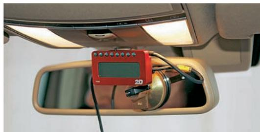
**Das Messgerät erfasst die Rundenzeiten auf der nassen und trockenen Handling-Strecke**
