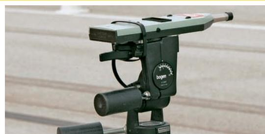
**Messung des Abrollgeräuschs. Der Testwagen passiert das Mikrophon im Leerlauf**
